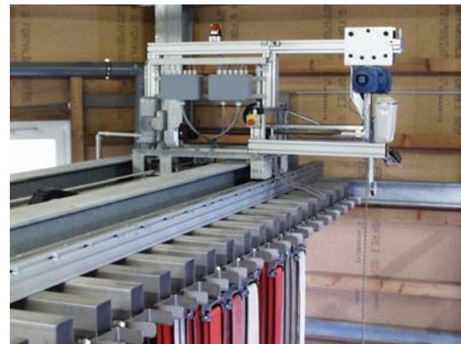
( Schlauchbahnen aus Edelstahl in Verbindung mit unserem eloxierten Aluminium-Profilsystem geben der Korrosion kein Chance )
