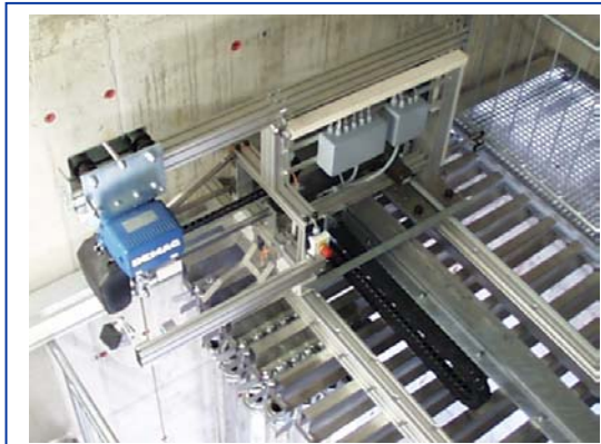
( Spezielle Führungswellen aus gehärtetem Edelstahl ermöglichen eine optimale Führung des gesamten Aufbaus, bei extrem langer Lebensdauer. )
