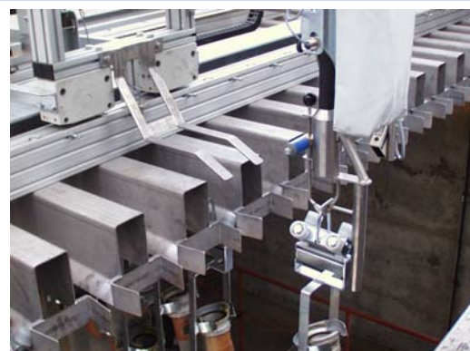
( Vier Kugelgelagerte Laufrollen ermöglichen eine optimale, verdrehsichere Führung der Adapter in den Schlauchbahnen. )
