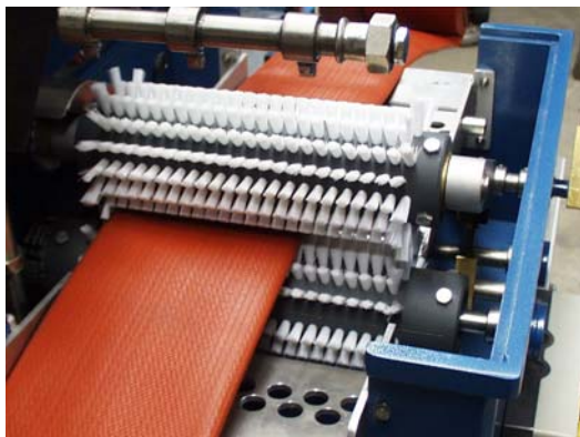
( Kurze, harten Borsten ermöglichen eine optimale Reinigung und lange Lebensdauer. )
