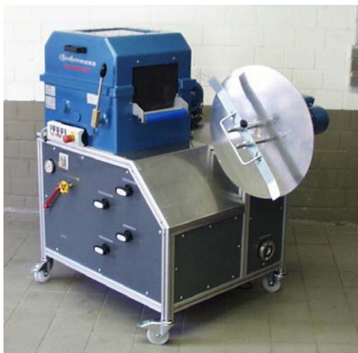
( Wickler in schwenkbarer Ausführung hier für gleichzeitigem Wasch-Wickelbetrieb. )
