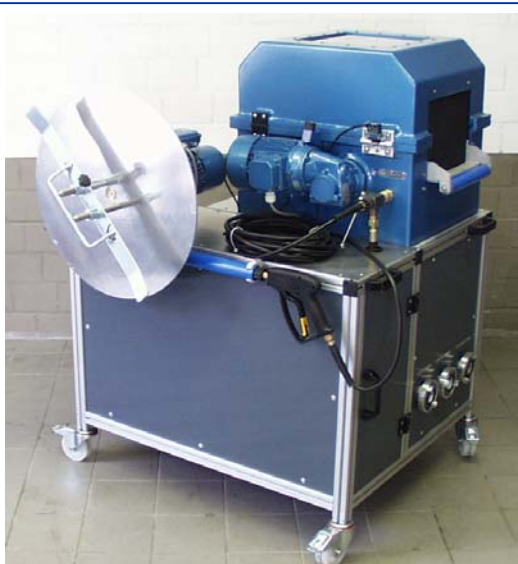
( Wickler seitlich neben das SPZ geschwenkt zum einfach oder hälftigem Wickeln der Schläuche. Bedienung über Fußstastschalter.)
