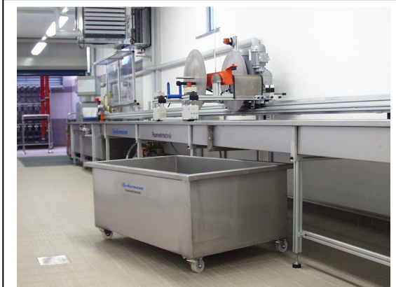
( Sonderentsorgungsbehälter oder Prüfwasserrückgewinnungsbehälter n fahrbarer Ausführung aus Edelstahl für ca. 500 ltr Inhalt )
